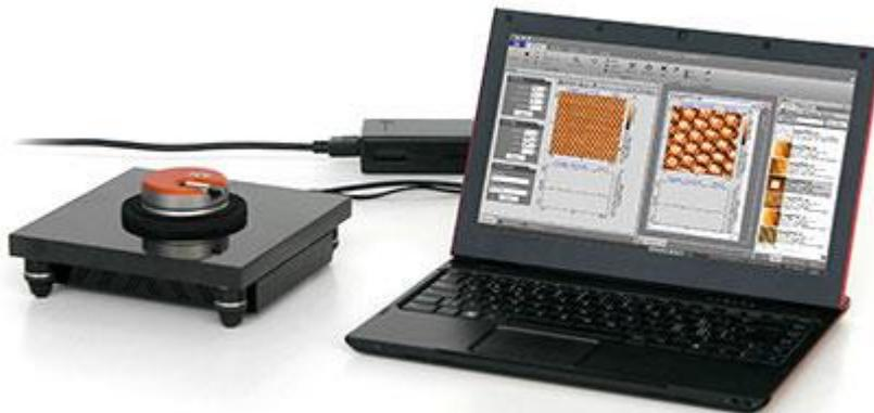
*Das Rastertunnelmikroskop von NanoSurf*
