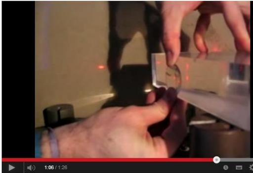
Aufgrund des Tunneleffekts ist es nun möglich, dass das Licht diese eigentlich unüberwindliche Barriere überwindet. Dies lässt sich in einem Experiment mit zwei Prismen nachweisen. Sie können sich das Experiment unter <http://www.youtube.com/watch?v=aC-4iSD2aRA> ansehen.
