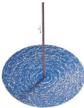
Versuche dies zu überprüfen indem du feine Eisenspäne auf ein Blatt Papier streust und ein Draht durch die Mitte des Papiers steckst. Wenn ein genug starker Gleichstrom durch den Draht fließt, dann richten sich die Eisenspäne nach dem magnetischen Feld aus.
