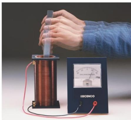
Das kannst du ebenfalls ausprobieren. Frage nach einem sensitiven Amperemeter, einer Spule und einem Magnet.
