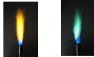
*Abbildung 9 Natrium (Na), das in eine Flamme gehalten wird, weist eine charakteristische gelbe Färbung auf. Wird dasselbe mit Kupfer (Cu) gemacht, sieht man eine typische Blaufärbung.*
