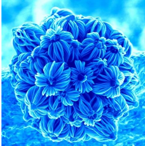
Abbildung 15. Das Siegerbild des Fotowettbewerbs 2004 der Fakultät für Ingenieurwissenschaft wurde von Ghim Wei Ho vom Zentrum für Nanowissenschaften aufgenommen. Die dreidimensionale Nanostruktur auf ihrem Foto besteht aus einem Material auf Silikonbasis. Es wurde mithilfe einer chemischen Gasphasenabscheidung hergestellt. Das Material ist sowohl amorph als auch kristallin. Das Bild wurde mit einem Rasterelektronenmikroskop aufgenommen.
