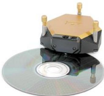
Abbildung 2: AFM Messungen einer Compact Disc. Die geschätzte Zeit, um ein 3-dimensionales Bild zu erhalten, ist 10 Minuten.
